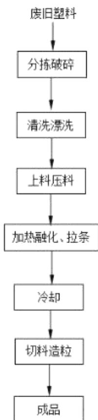
图 3-4 本项目生产工艺流程与产污环节图
