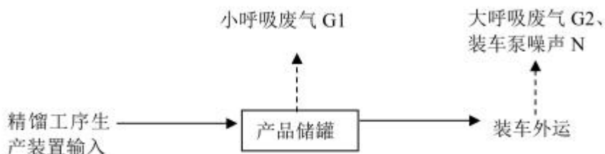
图 2-3 本项目营运期生产工艺流程及产污环节图
