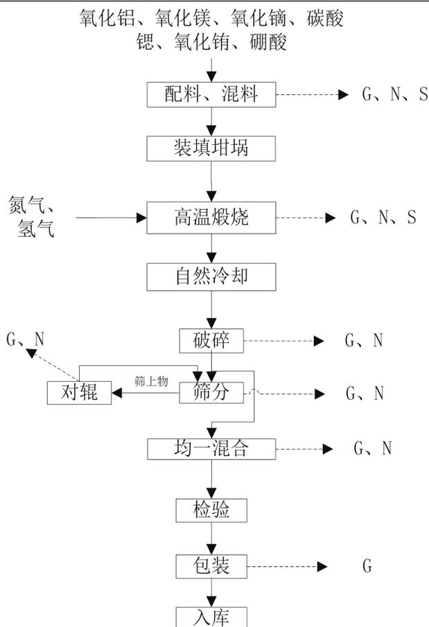
图 2-4 长余辉发光粉生产工艺及产污环节图
