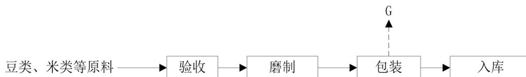
图 2-8 杂粮面项目生产工艺流程及产污环节图
