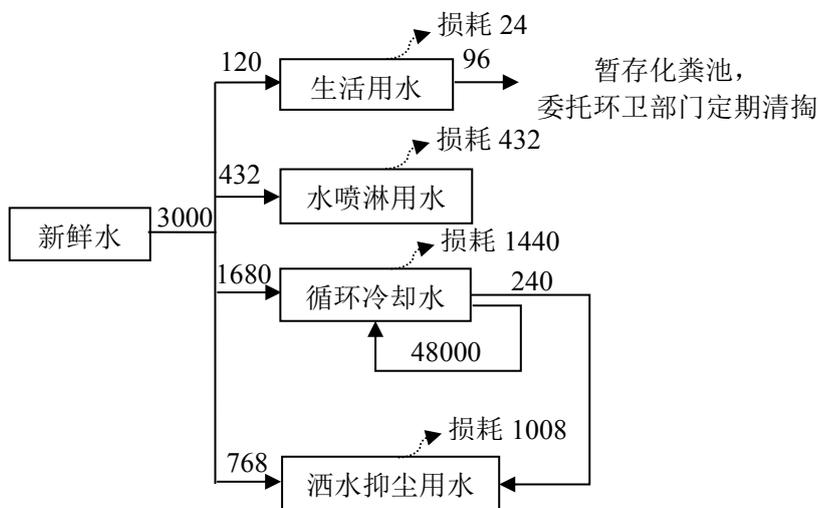
图 3-3 水平衡图 (m³/a)
