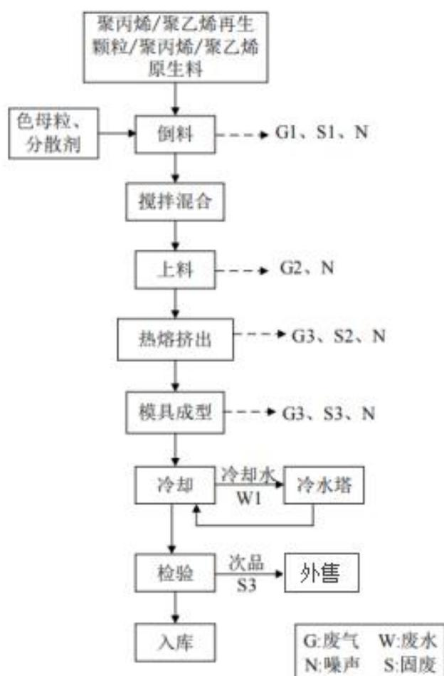
图 3-4 本项目生产工艺流程与产污环节图
