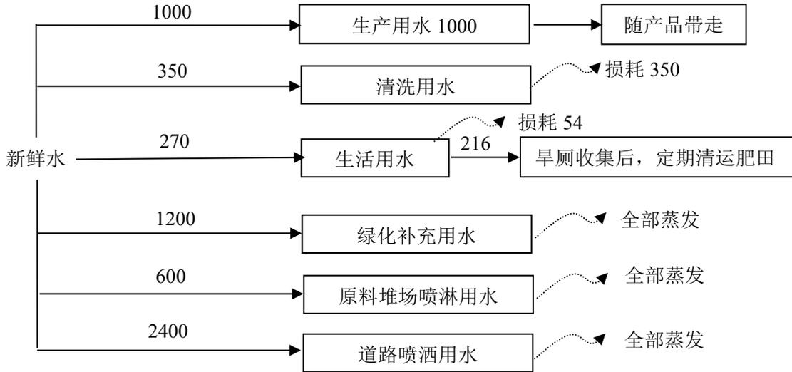
图 2-3 本项目水平衡图 (m³/a)
