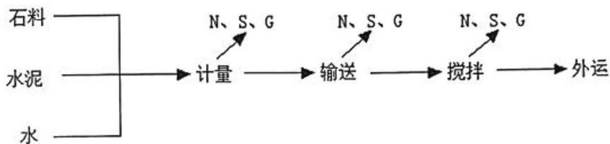
图 2-4 碎石稳定土生产工艺流程及产污环节图
